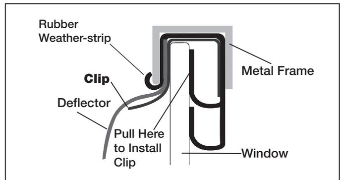
**2** View of proper installation. *Vista de la instalación correcta.*
