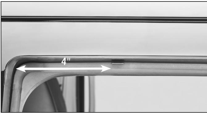
**5** Pull down the 2nd weather-strip in the front installation location with the provided tool, approximately 4" from the front. Then, push clip in, and replace weather-strip. *En la ubicación de la instalación de la parte delantera, tire de los 2 burletes hacia abajo con la herramienta provista, aproximadamente 4 pulgadas de la parte frontal. Luego empuje la grapa hacia adentro y vuelva a colocar los burletes.*
